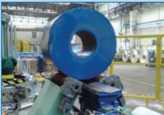
Balicí linka svitků pocínovaných plechů se zakládacím hydraulickým vozíkem, ovinovacím automatem a s překlápěčkou zabalených svitků
