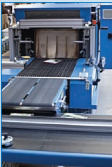
Bezúdržbový tunelový dopravník s akumulčním koncovým dopravníkem s počítačací funkcí
